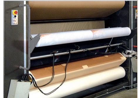
Im **Digitaldruck-Transferdruck** wird der Druck vom Transfermedium durch Hitze auf den Stoff übertragen. Bei diesem Produktionsverfahren Transferdruck erfolgt der Druck zunächst auf einem Transferpapier. Durch Heißkalandern wird die Farbe danach vom Papier auf den Stoff übertragen. Der Digital-Transferdruck ermöglicht die Realisierung eines sehr feinen und farbbrillanten Druckbildes auf einer Seite des Stoffes.
