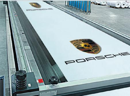
Das **Dampfdurchdruckverfahren** ermöglicht durch modernste Druckmaschinen eine präzise Produktion Ihrer Fahnen. Auf bis zu 70 m langen, modernen High-Tech-Druckmaschinen, lassen sich auf einer Stoffbreite von bis zu 200 cm die unterschiedlichsten Stoffe im chemischen Siebdruck (fast) unendlich lang bedrucken. Sowohl Sonderfarben als auch Druckdarstellungen im 4c-Rasterdruck tragen zu perfekten Druckergebnissen mit höchster Lichtechtheit und Farbbrillanz bei. Für optimale Druckergebnisse werden
