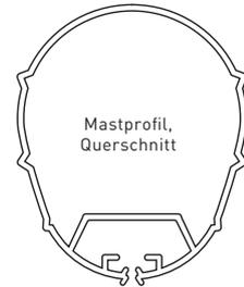
Die Masten beider Serien sind aus silberfarben eloxiertem Hartaluminium mit gerillter Oberfläche und mit innenliegender Hissvorrichtung ausgestattet. Während bei den Strato Turn-Masten ein Hißschloss für zusätzliche Sicherheit sorgt, verfügen die Solanus Turn-Masten über eine Drehkurbel zum noch bequemeren Hissen. Der Diebstahlschutz ist hier durch die abnehmbare Drehkurbel sichergestellt.
