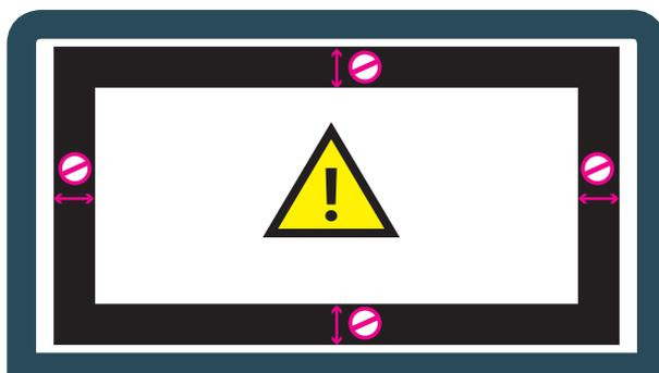
Vermeiden Sie bei der Gestaltung gleichmäßige, farbige Rahmen am Layoutrand. Diese können Produktionstechnisch (Der Bedruckstoff hat bis zu 3% Zug und Schrumpf) beim **maschinellen** Zuschnitt nicht gehalten werden.
